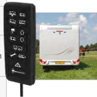
Le funzioni Traghetto, Fuoristrada e Parcheggio permettono di regolare temporaneamente il livello di marcia a una velocità massima di 30 km/h. Le altre funzioni possono essere attivate solo quando il veicolo è fermo.
